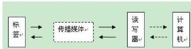
图3 RFID系统原理图
