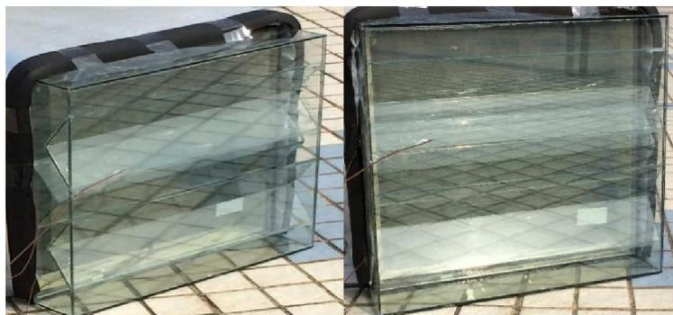
图 14TAPG 玻璃外墙实物图
