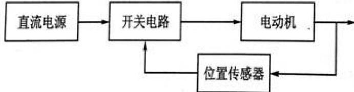
图1 无刷直流电动机的原理框图
